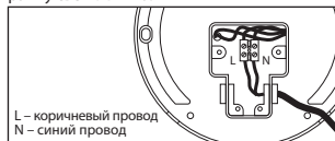
5.5. Подключите светильник к электрической сети с помощью клеммной колодки.
